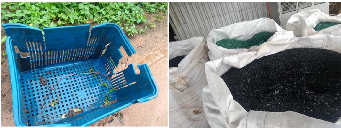
Figura 2 - Transformação e recuperação do PEAD
